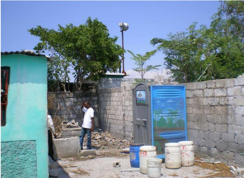
Le mur du fond N°2 sur le plan, est à détruire et reconstruire, il sépare les nouvelles classes espérées des anciennes. Une large porte y sera posée. Entrée des élèves ou issue de secours. L'arbre sera abattu et remplacé par d'autres après la construction.
